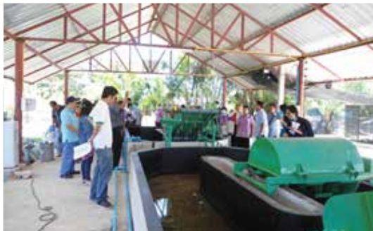
ฐานเรียนรู้ที่ ๓ วิธีการนำขยะที่ใช้ก๊าซผลิตไฟฟ้า เสร็จเรียบร้อยแล้วมาคัดร่อนแยก และแปรรูปเป็นวัสดุก่อสร้างและพลังงาน
